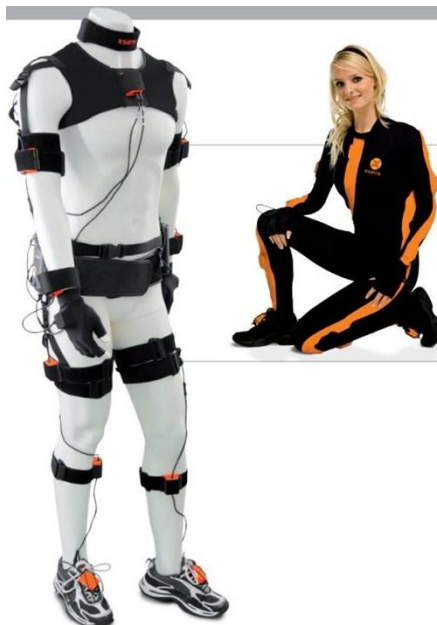
Рисунок 2.10 - Система трекинга движений человека Xsens (костюм на основе инерциальных датчиков)
