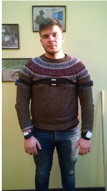
Рисунок 4.5 – Размещение беспроводных датчиков на поверхности различных сегментов и областей тела добровольца
