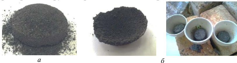
Рисунок 7 - Образцы, изготовленные из ХНПМ: а – без добавки; б – с добавкой
