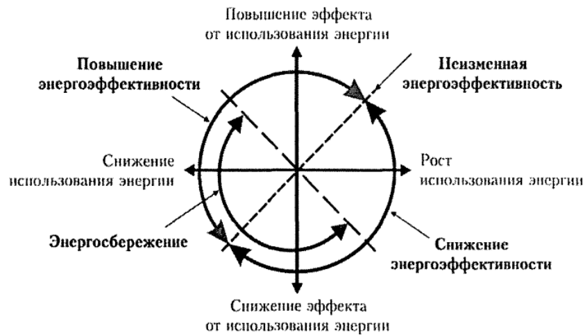
Рисунок 1.5 – Определение разницы между повышением энергоэффективности и энергосбережением
