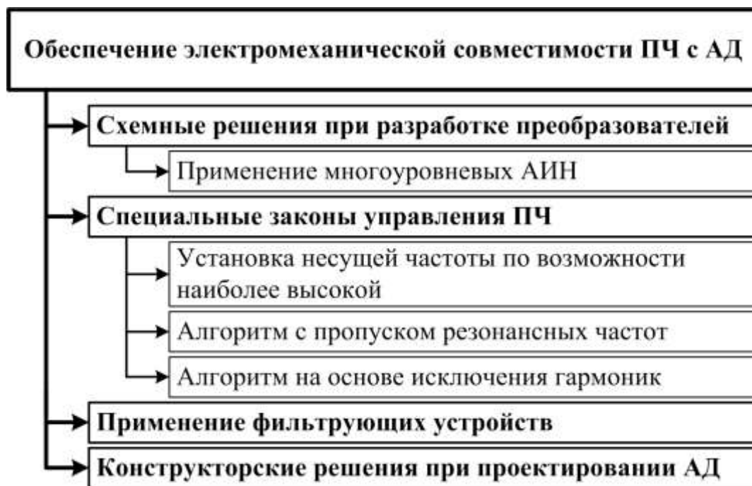
Рисунок 1.18 – Классификация способов обеспечения электромеханической совместимости в асинхронных ЭП
