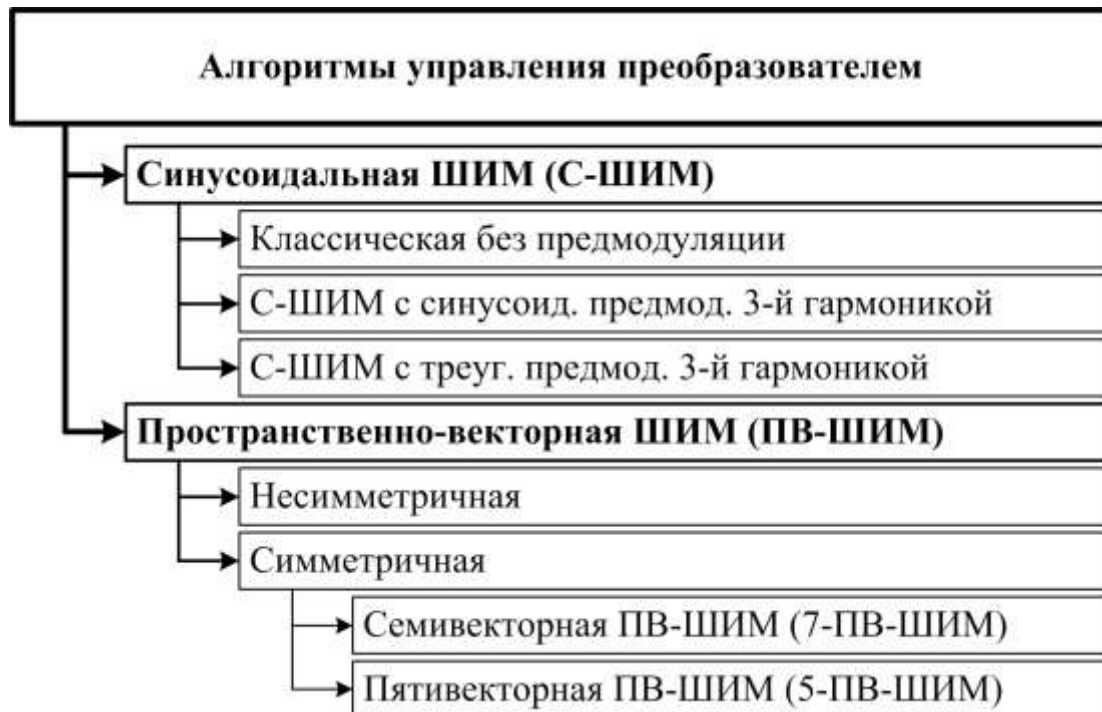
Рисунок 2.4 – Классификация алгоритмов управления преобразователем
