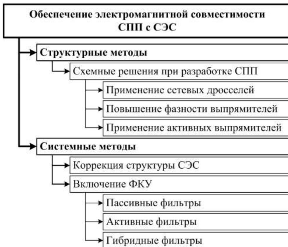
Рисунок 1.5 – Классификация методов обеспечения электромагнитной совместимости СПП с СЭС
