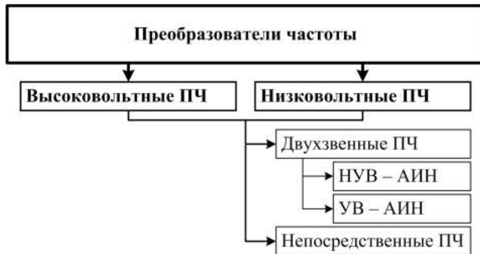
Рисунок 1.1 – Классификация ПЧ, применяемых в асинхронных ЭП
