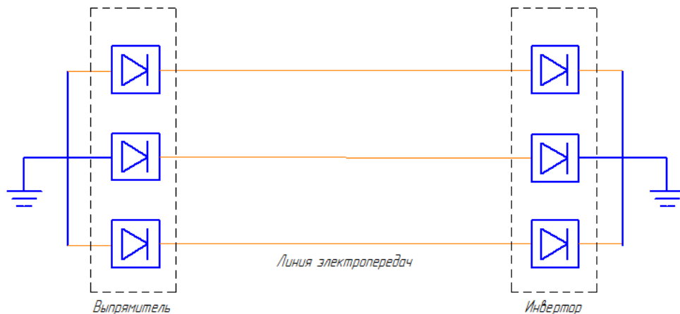
Рисунок 1.5.2 – Схема триполярной линии
