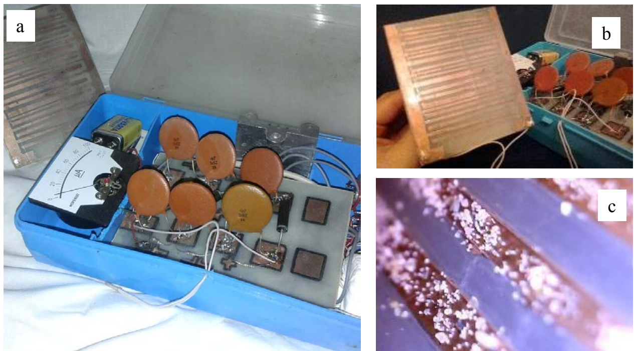
Рисунок 5.1 – Общий вид поляризационного сепаратора (a, b) и фото пластины с притянутыми к электродам частицами пробы (c)
