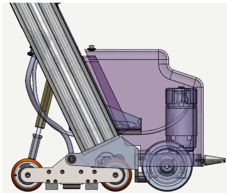
Рисунок 1.13 – Внутренне устройство сканера системы FLOORMAPVS2 .
