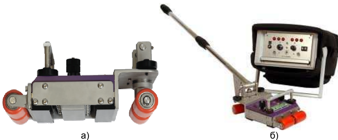
Рисунок 1.10 – Восемнадцатиканальный ручной преобразователь для контроля плоских поверхностей:
