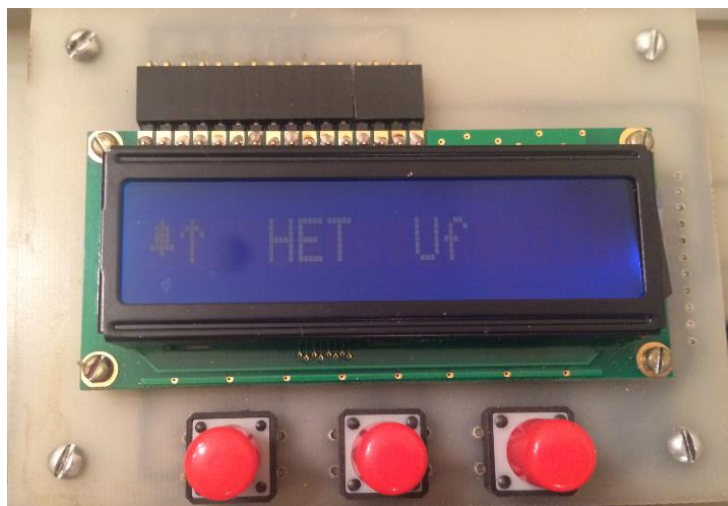
Рисунок 4.5 - Сигнал нарушения целостности вторичных цепей инвариантной защиты от ОЗЗ
