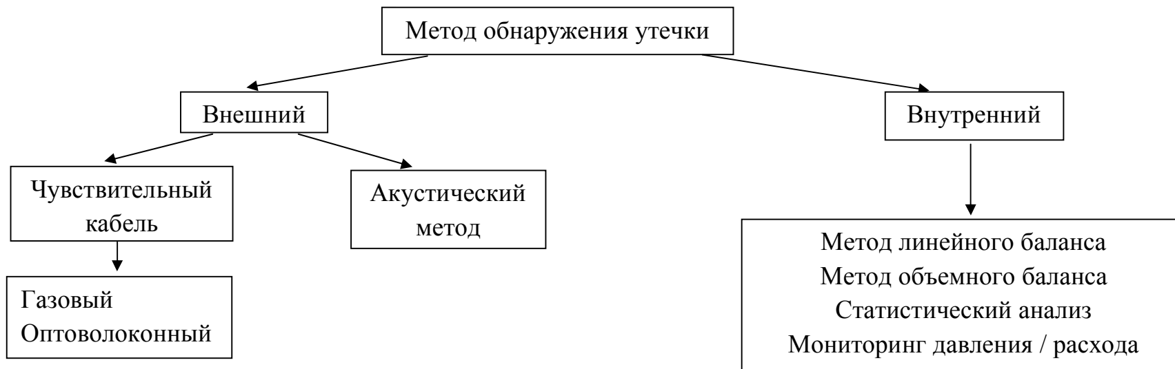
Рисунок 2.1 – Классификация современных методов обнаружения утечек
